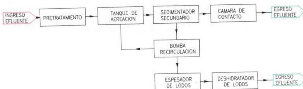
Figura 2. Diagrama de Flujo del proceso Barros Activados con aireación Extendida
